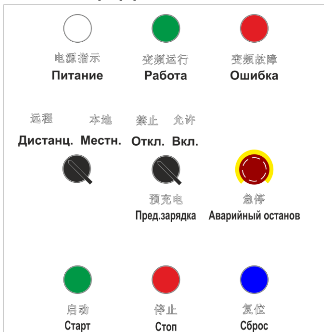
Рис. 24. Передняя панель шкафа управления
