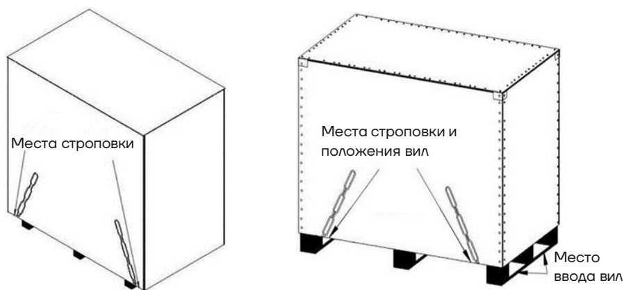
Рис. 10. Схема строповки (паллеты с выступом – слева, паллеты без выступа – справа)
