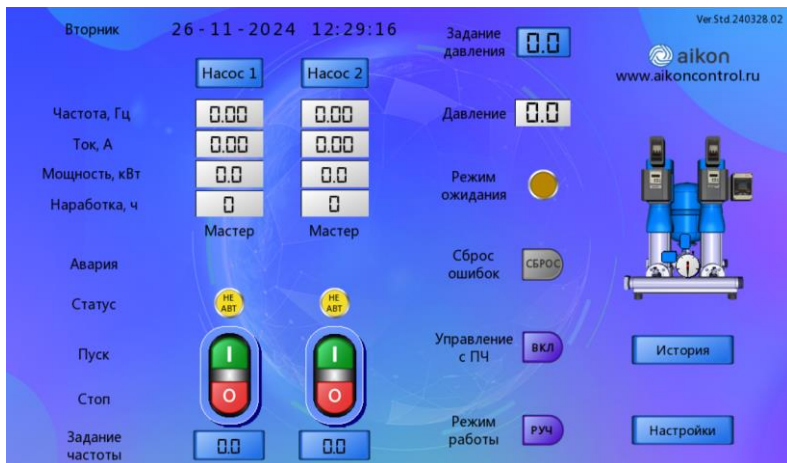
ГЛАВНЫЙ ЭКРАН ПАНЕЛИ УПРАВЛЕНИЯ С ПРОГРАММОЙ ДЛЯ ТРЕХ НАСОСОВ
